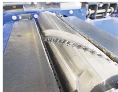
/ Die kombinierte Abrichte/Dicke Dual 51 von Format-4 hat die Silent-Power-Hobelwelle an Bord.
