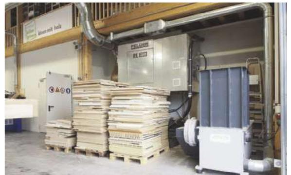
*/ Grimm verfügt über einen Zerkleinerer (r.) und Brikettierung. Der 100-kW-Kessel (Heizomat) speist auch einen 3000-Liter-Pufferspeicher.*
