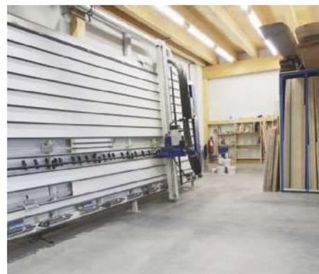
/ Der Zuschnitt erfolgt auf einer stehenden Plattensäge. Gleich daneben ist das kompakte Plattenlager.
