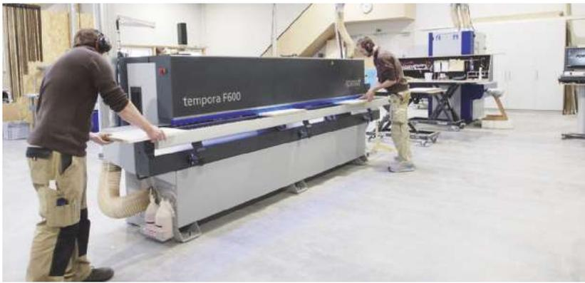
*/ Kompakt und doch voll gesteuert: Die Kantenanleimmaschine Tempora 60.06 L ist mit dem AdvantEdge-Heißlufttaggregat für Laserkanten und einem Schmelzklebebecken...*
