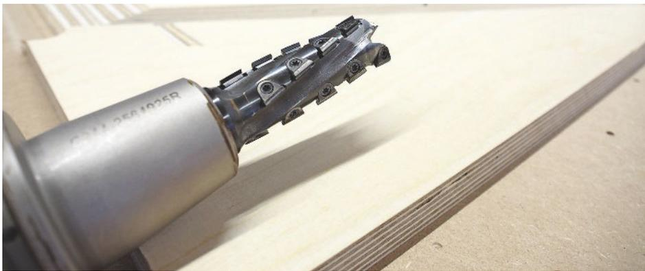
*/ Hohe Performance, einfaches Handling: Der Konstantin Mini von Aigner hat einen Durchmesser von 25 mm. Die 23 Dia-Schneiden lassen sich vom Anwender selber wechseln, Bohr- und Umfangschneiden sind identisch.*
