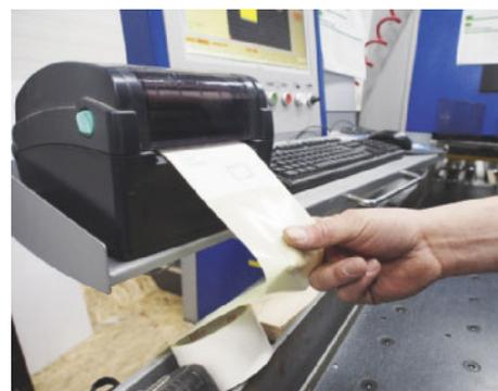
/ Die Etiketten werden direkt an der liegenden Plattensäge ausgedruckt und auf die Teile geklebt.
