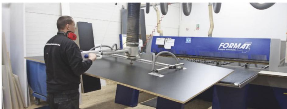
/ Der Plattenzuschnitt erfolgt auf einer Kappa Automatic, wobei ein Vakuumheber das Handling unterstützt. Neben der Schnittoptimierungssoftware Ardis sorgt die einfach bedienbare Format-4-Software für Produktivität.
