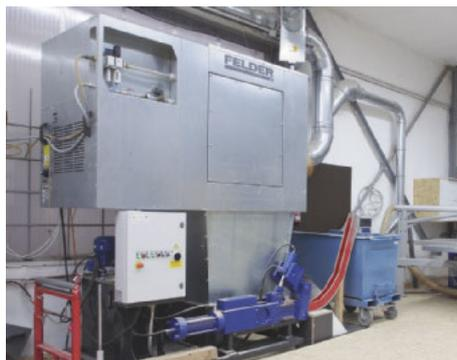
/ Entsorgung komplett: Der Entstauber ist mit einer automatischen Brikettierung gekoppelt.
