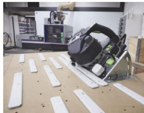
/ Pfiffig: Für die schnelle (auch schräge) Kante zwischen- durch kommt eine Conturo von Festool zum Einsatz.
