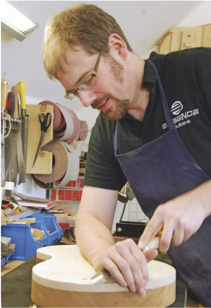
/ Zeitintensives Geschäft: Der 36-jährige Zupfinstrumentenmachermeister Tobias Ahlke arbeitet die gewölbte Decke einer Elektrogitarre mit dem Hohlbeitel aus.
