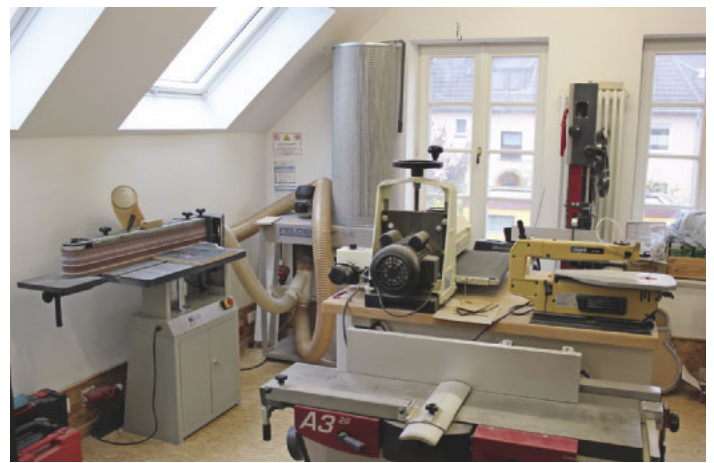
/ Kompakter Maschinenpark: Band- und Dekupiersäge, Abrichte, Kanten- und Zylinderschleifmaschine – alles ist perfekt auf den Instrumentenbau ausgerichtet.
