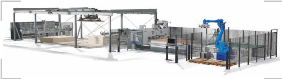
/ Felder ermöglicht mit dem Flächenlager C-Motion Dynamics eine automatisierte Plattenbearbeitung. Das System vereint eine dynamische Lagerlogistik mit präziser CNC-Steuerungstechnik.
