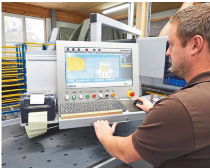
/ Die Plattenaufteilsäge hat ein großzügiges 24"-TFT-Bedienterminal an Bord. Auf dem Maschinen-PC ist auch die Zuschnittoptimierung Ardis installiert.
