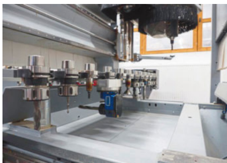
/ Blick in den Werkzeugwechsler des CNC-Bearbeitungszentrums.
