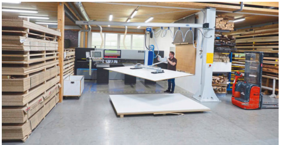
/ Die Schreinerei Ahollinger setzt auf leistungsstarken und flexiblen Zuschnitt auf der Plattenaufteilsäge Mayer Kappa Automatic 80. Beschickt wird die Maschine mit einem Vakuum-Hebegerät, nachdem ...
