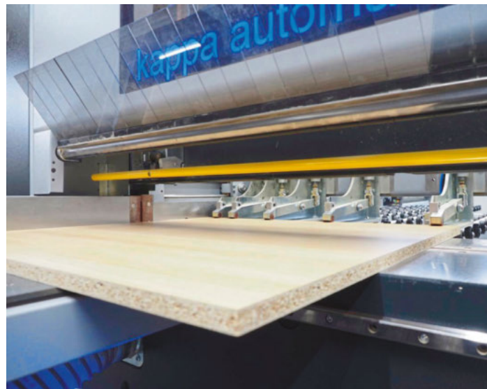
/ Die schwere Bauweise mit Druckbalken und Materialschieber aus Stahl sorgt für präzisen Plattenzuschnitt auf der Mayer Kappa Automatic 80.
