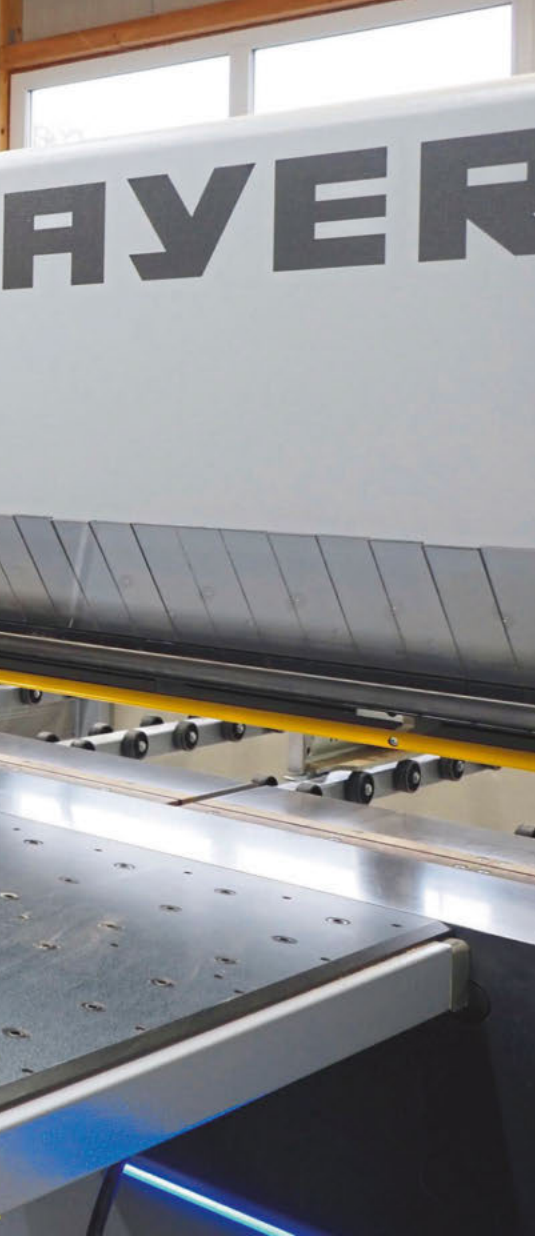
/ Die Schreinerei Ahollinger setzt auf leistungsstarken und flexiblen Zuschnitt auf der Plattenaufteilsäge Mayer Kappa Automatic 80. Beschickt wird die Maschine mit einem Vakuum-Hebegerät, nachdem ...
