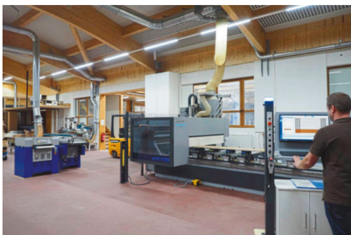
/ Mit dem 5-Achs-CNC-Bearbeitungszentrum Format4 Profit H350 ist die Schreinerei auch für individuelle Komplettbearbeitungen gerüstet.
