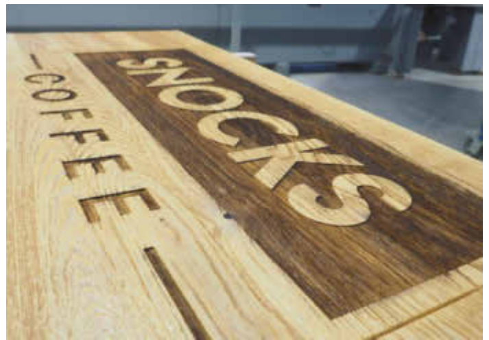
/ ... bei Massivholz spielt die Maschine ihre Stärken aus. Dieses Schild wurde auf der Findustry 1352 gebürstet und strukturiert sowie mit dem Trotec-Laser bearbeitet.
