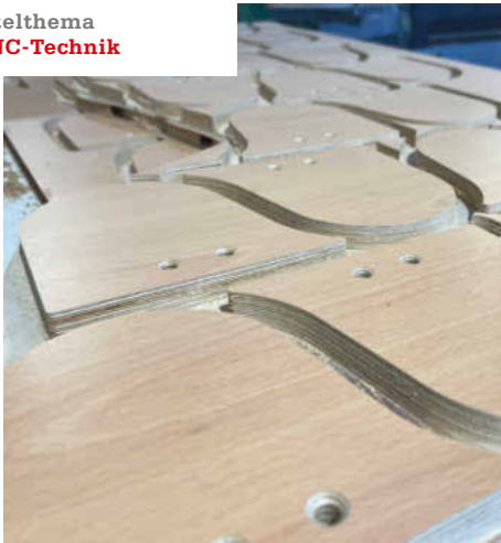
/ Auf der Format4-CNC Profit H150 stehen Nesting-anwendungen im Fokus, von Kleinteilen...
