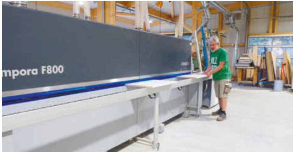
/ Voll gesteuert, flexibel und präzise: Jüngste Technologieinvestition der Schreinerei ist diese Kantenleimmaschine vom Typ Format4 Tempora F800.
