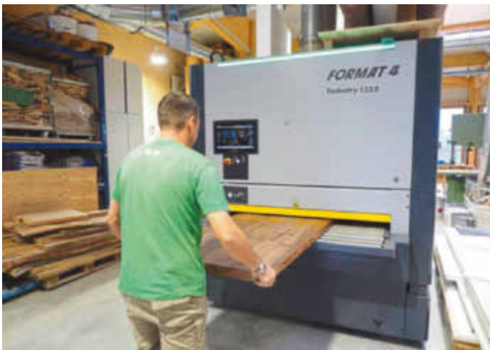
/ Die Breitbandschleifmaschine Format4 Findustry 1352 bietet eine Schleifbreite von 1350 mm sowie eine Schleifhöhe von 3 bis 170 mm. Besonders auch ...
