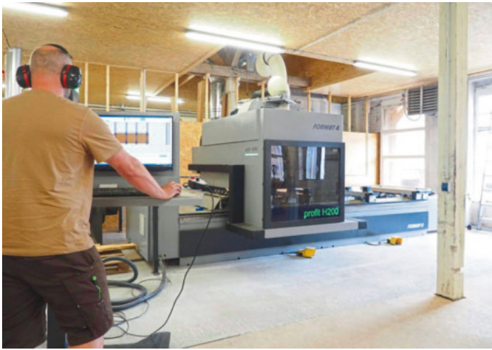
/ Zusammen mit den Standardmaschinen hat Feldheim auch die 3-Achs-CNC Format4 Profil H200 angeschafft. Programmiert wird aktuell noch direkt an der Maschine.
