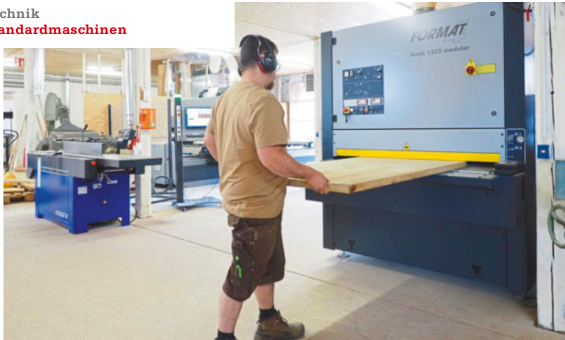
/ Die Breitbandschleifmaschine vom Typ Format4 Finish 1352 Modular bietet eine Schleifbreite von 1350 mm sowie eine Schleifhöhe von 3 bis 170 mm. Ausgestattet ist sie ...
