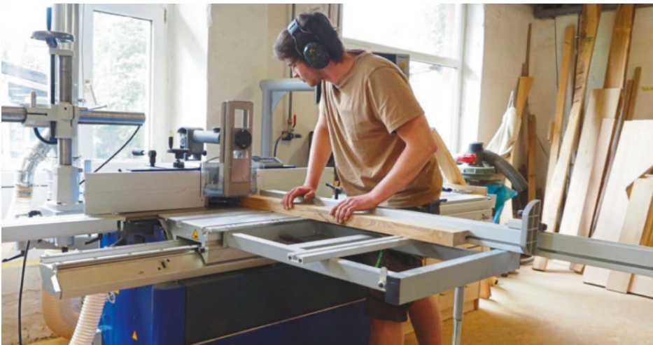
/ Ein präzises Multitalent ist die Tischfräse Format4 Profil 45 Z X-Motion. Der Auslegertisch ermöglicht die einfache Bearbeitung von großen, schweren Werkstücken oder die Querbearbeitung von Massivholzkanteln.
