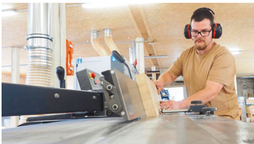
/ Die Abrichtobelmaschine Plan 51 L überzeugt mit 3 m Tischlänge. Der zuführende Abrichttisch bietet dabei mit 1650 mm Länge reichlich Auflagefläche für lange Werkstücke. Bestückt ist ...
