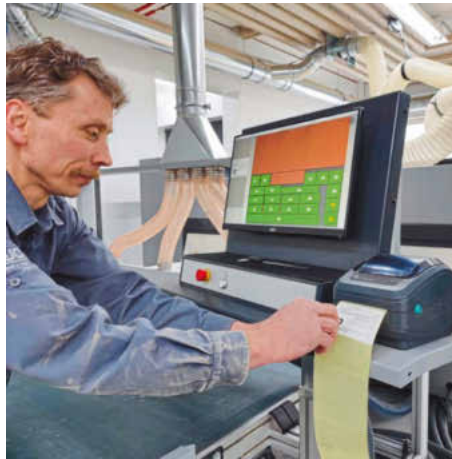
/ An der Entladestation befindet sich ein zusätzliches Bedienterminal mit Thermo-Etikettendrucker.
