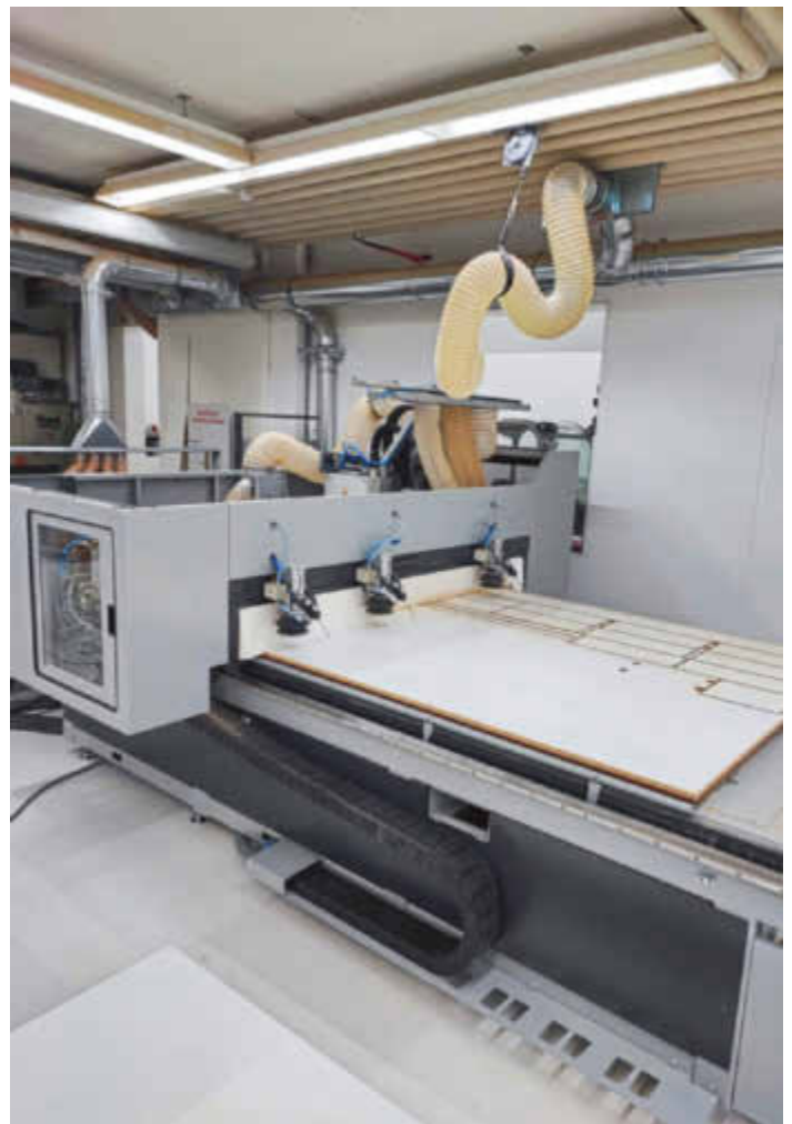
/ Durch den Nesting-Verbinder FixChip können die einzelnen Bauteile mit geringerem Abstand angeordnet und eine größere Ausbeute erzielt werden.
