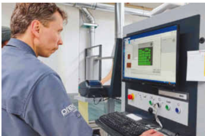
/ Über das Steuerterminal mit 24-Zoll-LED-Farbdisplay kann die Zuschnittoptimierung auch noch manuell angepasst werden.
