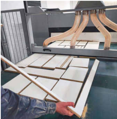
/ Die Oberfläche der Werkstücke wird durch die Oberflächensaugung am Transportband abgesaugt.
