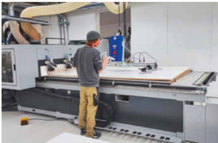
/ Mit einem Vakuum-Hebegerät werden die Platten manuell vom Stapel auf dem Maschinentisch der Nesting-CNC abgelegt und durch Anschlagssylinder positioniert.
