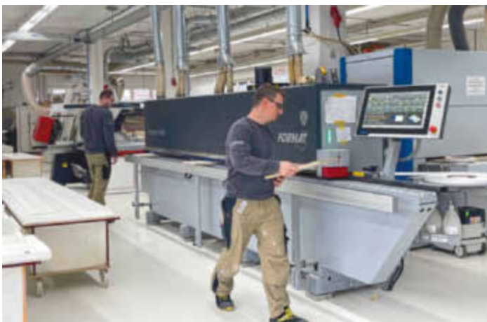
/ Die Kantenanleimmaschine Tempora F800 kann zeitlich parallel zur Nestingbearbeitung bestückt werden.
