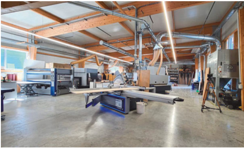
/ Schräge Anordnung, cleverer Durchlauf: In Halle 1 werden hauptsächlich Platten verarbeitet. Vorne im Standard an der Formatkreissäge, hinten geht's vom Stapler direkt auf die Nesting-CNC.
