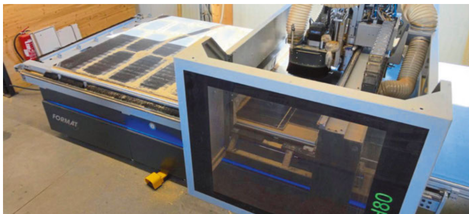
/ Zentraler Leistungsträger in der Plattenverarbeitung ist die neue Format 4 Profit H80 Nesting-CNC. Die Daten kommen direkt aus der Arbeitsvorbereitung, werden am Terminal noch in F4-Nest verschachtelt und los geht's.
