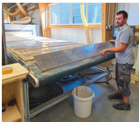
/ Der gesteuerte Abnahmetisch an der Profit H80 ermöglicht das unkomplizierte Entnehmen der fertigen Teile.
