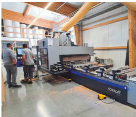
/ Für individuelle Formen und Zweitbearbeitungen steht der Mannschaft eine 5-Achs-CNC zur Verfügung.
