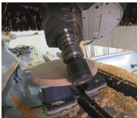
/ Mit der Format 4 Profit H350 fertigt die Schreinerei besondere Teile für ausgefallene Möbelstücke.
