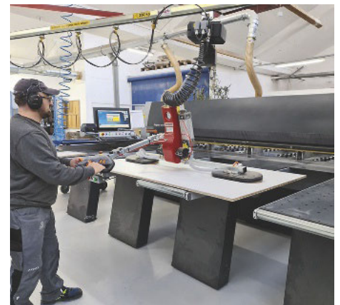
/ Mit Handlinggeräten von Barbaric kann ergonomisch und alleine bestückt und entladen werden.
