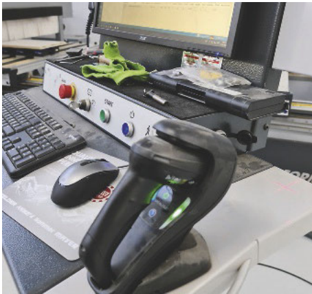
/ An der CNC wird der aufgeklebte Barcode der Teile gescannt, wodurch sich das richtige Programm öffnet.
