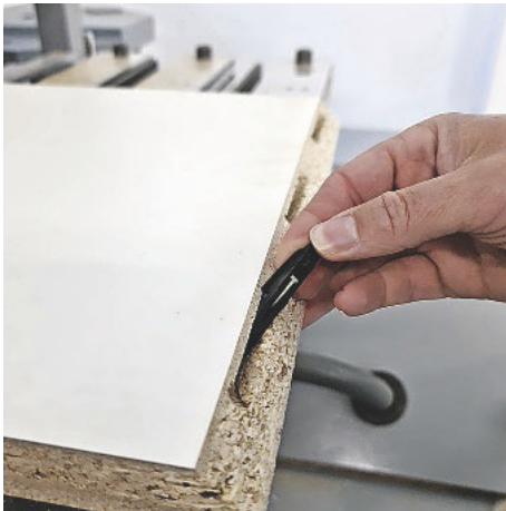
/ Für Plattenmöbel verwendet die Schreinerei Zezelj hauptsächlich den Clamex-Verbinder von Lamello.
