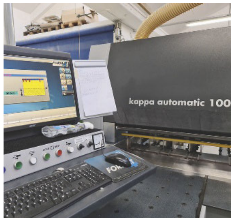
/ Die liegende Plattensäge wurde im Zuge der Umstrukturierung als erstes angeschafft.
