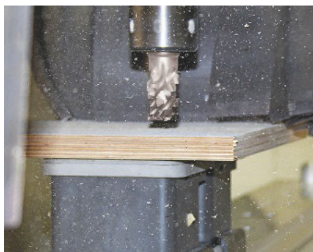
/ Der DP-Schaftfräser Z3 in Kombination mit dem rundlaufgenauen HP-Spannzangenfutter.
