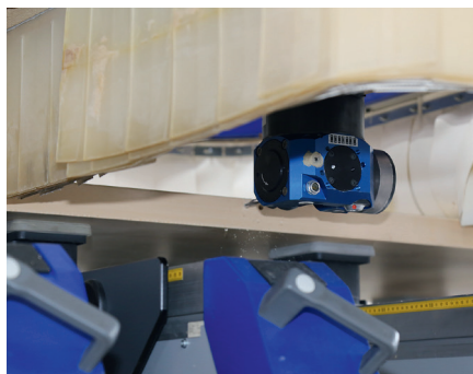
Die CNC-Maschine wird in der Tischlerei Prasser für Fräs- und Bohrarbeiten bei Möbeln und Türen eingesetzt. Die NC-Programme werden direkt an der Maschine erstellt.
