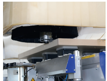
Die CNC-Maschine wird in der Tischlerei Prasser für Fräs- und Bohrarbeiten bei Möbeln und Türen eingesetzt. Die NC-Programme werden direkt an der Maschine erstellt.
