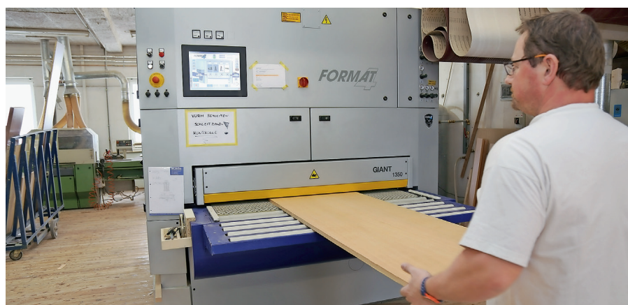
Jüngster Maschinenzugang: die Breitbandschleifmaschine Giant 1350 mit drei Schleifaggregaten.
