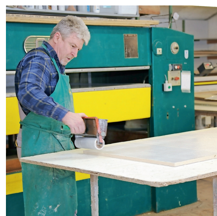
Leimauftrag für das Furnieren: Auch klassisches Handwerk ist bei Prasser noch gefragt.
