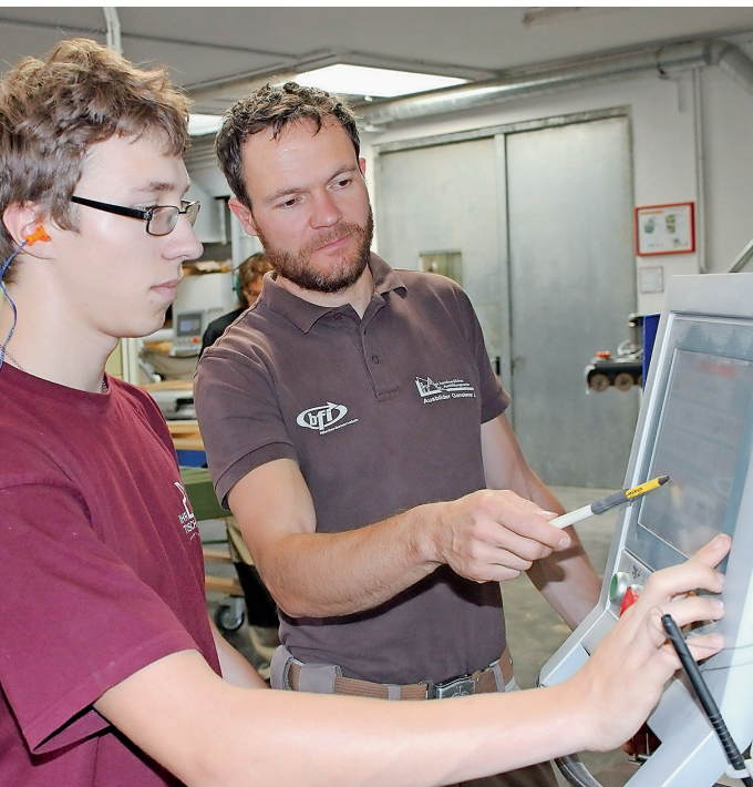
Computergesteuertes Kantenanleimen auf einer Format perfect 608
