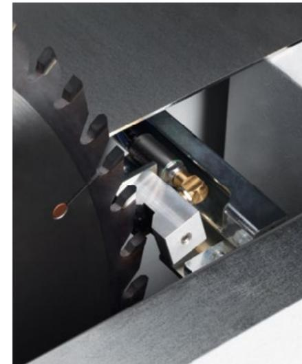
Sistema di lubrificazione minimale (MMS) per la lama integrato nel carro sega.
