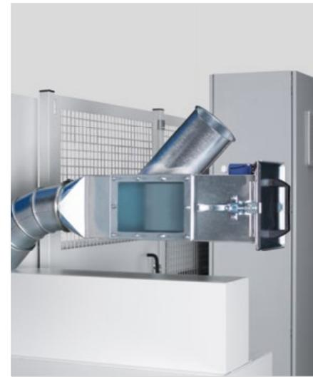
Il box di raccolta trucioli integrato impedisce l'ingresso di residui nel sistema di aspirazione.
