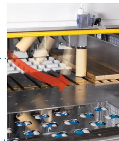
Pressore ad azionamento pneumatico per tagli a strisce.
