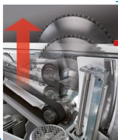
Regolazione continua dell' altezza lama con guida levigata trapezoidale con vite a ricircolo di sfere senza gioco.
