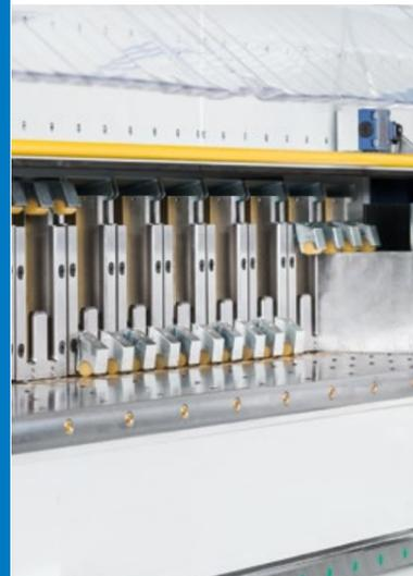
Pince de préhension multi-doigts pour une flexibilité maximale avec différentes largeurs de pièces.
