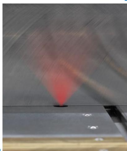
Système de mesure automatique de la longueur pour coupe de propreté.
