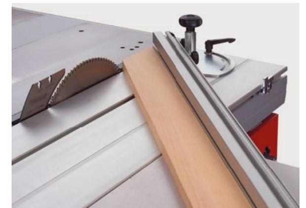
**Guía de corte para cortes de ángulo preciso**
