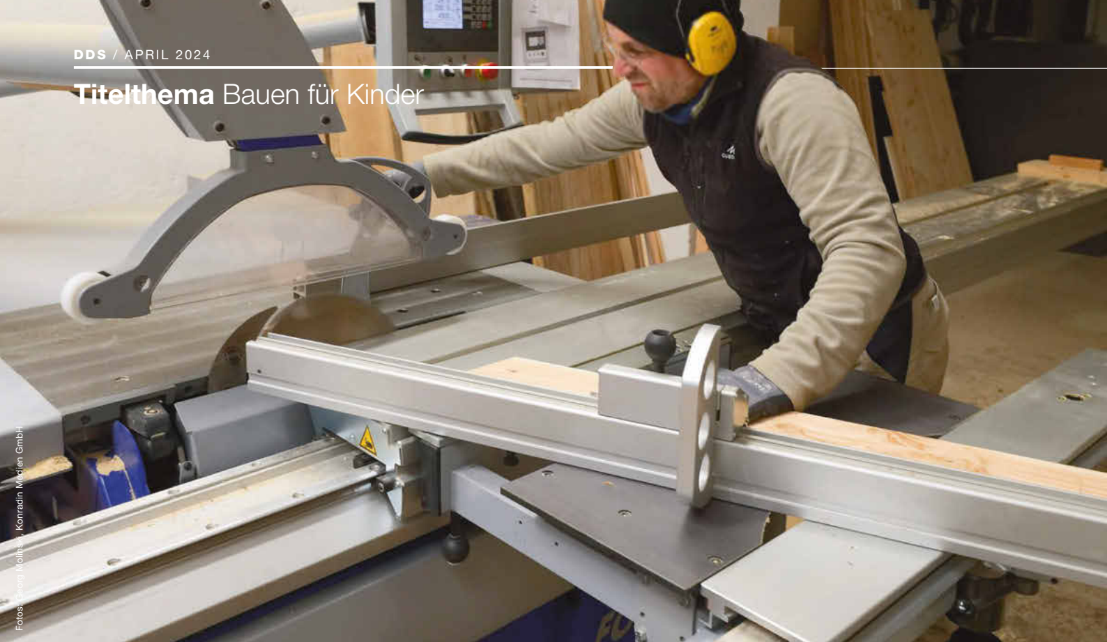
Udo Herderich arbeitet an Formatkreissäge Kappa 400 von Format4, angeschafft für komplexe, sich wiederholende Schnitte
