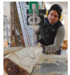
Udo Herderich fast die Pfosten für die Reling an der Bandsäge
